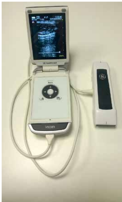
Kuva 1. Vscan Dual Probe, GE Healthcare. Kannettava ultraäänilaite, jossa sektori- ja lineaarianturit. Ohjelmat kardiologiaan, keuhkojen ja vatsan tutkimiseen ja obstetriikkaan. Noin kämmenen kokoinen. Paino 436 g. Kaikki tämän artikkelin kuvat on otettu Vscan Dual Probella.
