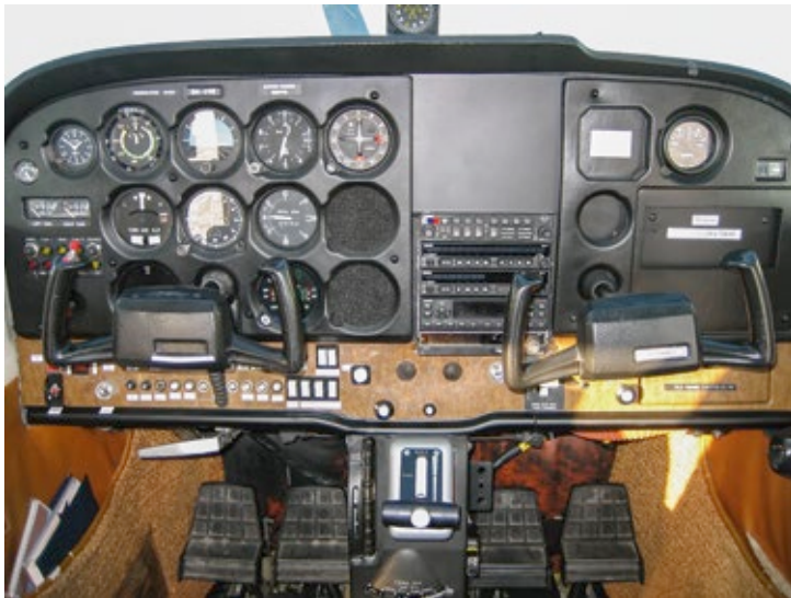
Tyypillinen Cessna 172 -lentokoneen mittaripaneeli. Vasemmalla lennon- ja moottorinvalvontamittarit. Koneessa on tietokoneohjattu dieselmoottori. Tarvittava teho valitaan alhaalla keskellä näkyvästä single-lever-tehovivusta. Kuva Jarmo Hintikka, 2018.
