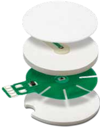
Kuva 4. SpotOn™ ZHF-ihoanturin kerrokset ylhäältä alas: ihoon liimattava tausta, potilaslämpömittarin termistori, eristävä vahtokerros, joustava piirilevy, eristävä vahtokerros.
