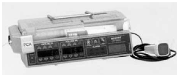
Kuva 1. PCS-menetelmään soveltuva Syramed µSP6000 PCA™ (Arcomed AG) infuusiopumppu, jossa on myös riittävän suurikokoinen itseannostelunäppäin.
